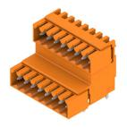
Doppelstöckige, versetzt angeordnete Stiftleiste für Wellenlötverfahren im Raster 3,50 mm. Die Stiftleiste steht in geschlossener und Flanschversion zur Verfügung. Die Stiftleisten bieten Platz für Beschriftungen und können kodiert werden.
