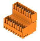
Doppelstöckige, versetzt angeordnete Stiftleiste für Wellenlötverfahren im Raster 3,50 mm. Die Stiftleiste steht in geschlossener und Flanschversion zur Verfügung. Die Stiftleisten bieten Platz für Beschriftungen und können kodiert werden.
