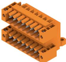
Doppelstöckige Stiftableiste für Wellenlötverfahren im Raster 3,50 mm. Die Stiftableiste steht in offener, geschlossener und Flanschversion zur Verfügung. Die Stiftableisten bieten Platz für Beschriftungen und können kodiert werden. Verpackung im Karton.
