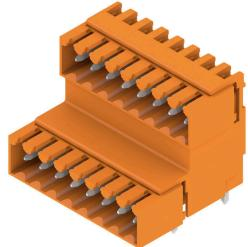
Doppelstöckige, versetzt angeordnete Stifteiste für Wellenlötverfahren im Raster 3,50 mm. Die Stifteiste steht in geschlossener und Flanschversion zur Verfügung. Die Stifteisten bieten Platz für Beschriftungen und können kodiert werden.
