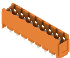
Stiftleisten aus glasfaserverstärktem Kunststoff mit gerader Abgangsrichtung optimiert für den Wellenlötprozess. Die Variante mit Flansch (F) lässt sich zur Verschraubung mit dem jeweiligen Gegenstück oder der Leiterplatte nutzen. Beim Einsatz der Lötplansch-Variante entfällt eine zusätzliche Verschraubung mit der Leiterplatte. Gleichzeitig werden die Lötstellen vor mechanischem Stress geschützt. Die Stiftleisten können manuell kodiert oder bereits vorkodiert bestellt werden. HC = High Current.
