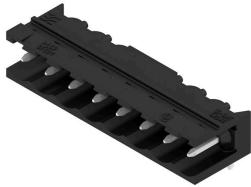
Hochtemperaturfeste, 90° abgewinkelte, offene Stifteiste. Verpackung in Box oder Tape. Im Tape mit 1,5 mm Lötstift optimiert für die Automatenbestückung. Lötstift 3,2 mm für Reflow- und Wellenlötanwendungen geeignet. Die Stifteisten sind beschriftbar und können kodiert werden. HC = High Current.
