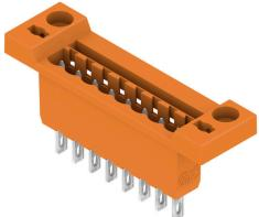
Durchführungsstifteleiste zur Frontplattenmontage mit optionaler Verriegelungsfunktion. Der interne Anschluss erfolgt als Flachsteck- oder Lötanschluss. Die Stifteleisten sind beschriftbar und können kodiert werden.
