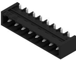
Hochtemperaturfeste, gerade, offene Stiftleiste. Verpackung in Box oder Tape. Im Tape und mit 1,5 mm Lötstift optimiert für die Automatenbestückung. Lötstift 3,2 mm für Reflow- und Wellenlötanwendungen geeignet. Die Stiftleisten sind beschriftbar und können kodiert werden. HC = High Current.
