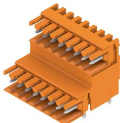
Doppelstöckige, versetzt angeordnete Stifteleiste für Wellenlötverfahren im Raster 3,50 mm. Die Stifteleiste steht in geschlossener und Flanschversion zur Verfügung. Die Stifteleisten bieten Platz für Beschriftungen und können kodiert werden.
