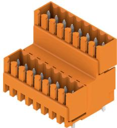
Doppelstöckige, versetzt angeordnete Stifteleiste für Wellenlötverfahren im Raster 3,50 mm. Die Stifteleiste steht in geschlossener und Flanschversion zur Verfügung. Die Stifteleisten bieten Platz für Beschriftungen und können kodiert werden.
