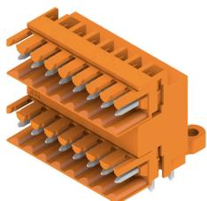
Doppelstöckige Stifteleiste für Wellenlötverfahren im Raster 3,50 mm. Die Stifteleiste steht in offener, geschlossener und Flanschversion zur Verfügung. Die Stifteleisten bieten Platz für Beschriftungen und können kodiert werden. Verpackung im Karton.
