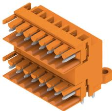
Doppelstöckige Stiftleiste für Wellenlotverfahren im Raster 3,50 mm. Die Stiftleiste steht in offener, geschlossener und Flanschversion zur Verfügung. Die Stiftleisten bieten Platz für Beschriftungen und können kodiert werden. Verpackung im Karton.
