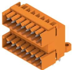
Doppelstöckige Stifteleiste für Wellenlötnverfahren im Raster 3,50 mm. Die Stifteleiste steht in offener, geschlossener und Flanschversion zur Verfügung. Die Stifteleisten bieten Platz für Beschriftungen und können kodiert werden. Verpackung im Karton.
