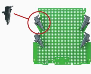
Stiftleisten mit optimierter Lötstiftlänge für Wellenlötanwendungen. Die Stiftleisten bieten Platz für Beschriftungen und können kodiert werden.
