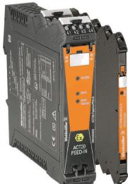
Stromversorgungsadaptermodul zur separaten Einspeisung und Verteilung der Versorgungsspannung für die ACT20 Series/ MICROSERIES Signalwandler. Die 22,5/ 6,1 mm breiten Einspeisemodule werden direkt neben den Analogsignalwählern montiert, dabei wird die 24 VDC Versorgungsspannung optional über den Tragschienenbus CH20M (ACT20- Series) oder einfach über steckbare ZQV 4N Querverbindungen (MICROSERIES) gebrückt.
