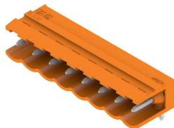
Stiftableisten mit 90° Abgangsrichtung. Die Lötstiftlänge ist für Wellenlötanwendungen optimiert. Die Stiftableisten bieten Platz für Beschriftungen und können kodiert werden.
