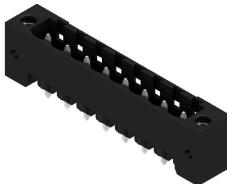
Hochtemperaturfeste Stiftleiste mit Verpackung in Box oder Tape. Im Tape mit 1,5 mm Lötstift optimiert für die Automatenbestückung. Lötstift 3,2 mm für Reflow- und Wellenlötanwendungen geeignet. Die Stiftleisten sind beschriftbar und können kodiert werden. HC = High Current.
