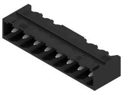
Hochtemperaturfeste Stiftleiste mit Verpackung in Box oder Tape. Im Tape mit 1,5 mm Lötstift optimiert für die Automatenbestückung. Lötstift 3,2 mm für Reflow- und Wellenlötanwendungen geeignet. Die Stiftleisten sind beschriftbar und können kodiert werden. HC = High Current.
