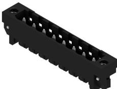
Hochtemperaturfeste Stifteleiste mit Verpackung in Box oder Tape. Im Tape mit 1,5 mm Lötstift optimiert für die Automatenbestückung. Lötstift 3,2 mm für Reflow- und Wellenlötanwendungen geeignet. Die Stifteleisten sind beschriftbar und können kodiert werden. HC = High Current.
