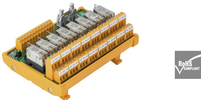
Relaissockel (RSM) mit gemeinsamem Plus- und Minuspotenzial für Anschluss an SPS oder andere Steuerungskomponenten. Die Schnittstellen bestehen aus Gruppen von 4, 8 oder 16 RCL-Relais (12,7 mm) oder RSS-Relais (6,1 mm). Der Controlleranschluss kann mit steckbaren Verbindungselementen oder per Direktverkabelung mit IEC 60603-13-Steckern vorbereitet werden. Breites Auswahlspektrum:
