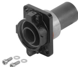
Das schützende Gehäuse ist aus einem seewasserbeständigen Aluminium im Druckgussverfahren hergestellt. Hohe Anforderungen an Wasser – und Staubschutz, so wie eine besonders hohe Schlagfestigkeit zeichnet diese Gehäusereihe aus. Eine aufwendige, zweistufige Oberflächenbeschichtung schafft Sicherheit für Jahre. Alle im Außenbereich verwendeten Schrauben, Verriegelungsbügel und sonstigen Zubehörteile sind aus korrosionsresistentem Edelstahl gefertigt.
