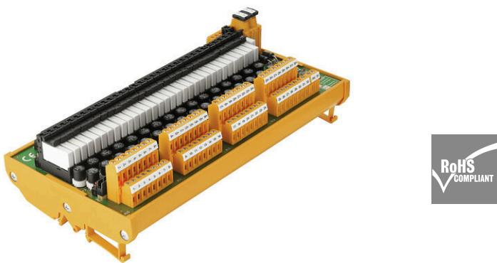
Die Relaisschnittstellen für digitale Eingänge isolieren die Feldsensoren von der Karte und/oder passen die Funktionsweise der vorgenannten Elemente auf die für das DCS erforderliche Spannung an. Die Schnittstellen unterstützen weitere Eigenschaften mit den folgenden Vorteilen, z. B.:
