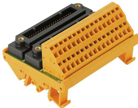
Analogschnittstellen sind mit 40-poligen Steckverbindern (KS) versehen. Die Versionen mit Trennsteckern und Prüfabgriffen sind bestens für Spannungs- und Strommessungen geeignet. Die Versionen mit nützlichen Zusatzstiften sind für den Kunden interessant, der mit weiteren Elementen (z. B. Widerstände) Strom/Spannung umwandeln oder Stromschleifen überwachen will.
