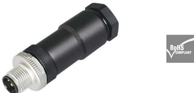
Ihre Geräte in der Peripherie sollen mit großer Leistung versorgt werden. Mit unseren neuen M12-Steckverbindern sind mehr als 250 V und 2 A problemlos möglich. Die kompakten A-, K-, L-, S- und T-codierten M12-Steckverbindern sind auf die Übertragung von bis zu 630 V AC bzw. 60 V DC und 12 A ausgelegt.
