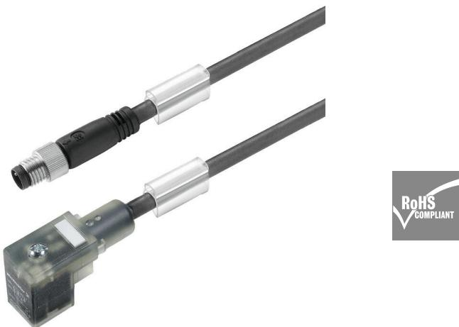
Weidmüller bietet Ventilstecker als Verbindungsleitung mit M8/M12 Steckern und mit freiem Leitungsende an. Der Betriebszustand des Ventilsteckers wird durch ein LED angezeigt. Die Ventilstecker besitzen eine Schutzbeschaltung. Das Weidmüllerlieferprogramm umfasst Ventilstecker der Bauformen A, B, C nach DIN und Industriestandard. Die Schutzart IP 67 wird im verschraubten Zustand erfüllt. Die Abgangsrichtung ist gleichfalls entscheidend, daher bietet Weidmüller unterschiedliche Versionen an.
