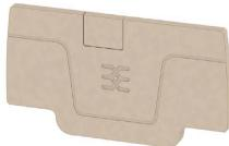
Abschlussplatten werden an der offenen Seite der letzten Reihenklemme vor dem Endwinkel befestigt. Mit dem Einsatz der Abschlussplatte wird die Funktion der Reihenklemme sowie die angegebenen Bemessungsspannung aufrechterhalten. Ein Berührungsschutz von Spannungsführenden Teilen wird gewährleistet, und die Abschlussklemme ist fingersicher.
