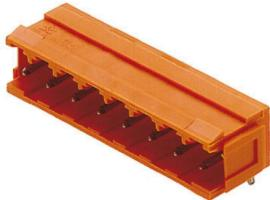
Dimensionsstabile, abgewinkelte, kodierbare Stiftleiste mit dem integrierten Fehlsteckschutz der Unimate Range Steckerfamilie. Erhältlich in seitlich offener oder geschlossener Ausführung. Bei der geschlossenen Variante lassen sich Befestigungsblöcke aufrasten. Die Lötstiftlänge 3,2 mm ist für das Wellenlöten optimiert. Lieferung erfolgt in Kartonverpackung.
