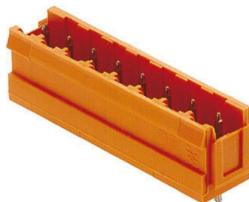
Dimensionsstabile, gerade, kodierbare Stiftleiste mit dem integrierten Fehlsteckschutz der Unimate Range Steckerfamilie. Erhältlich in seitlich offener oder geschlossener Ausführung. Bei der geschlossenen Variante lassen sich Befestigungsblöcke aufrasten. Die Lötstiftlänge 3,2 mm ist für das Wellenlöten optimiert. Lieferung erfolgt in Kartonverpackung.
