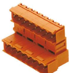
Dimensionsstabile, abgewinkelte, kodierbare, doppelstöckige Stiftleiste mit dem integrierten Fehlsteckschutz der Unimate Range Steckerfamilie. Erhältlich in seitlich offener oder geschlossener Ausführung. Bei der geschlossenen Variante lassen sich Befestigungsblöcke aufrasten. Die Lötstiftlänge 3,2 mm ist für das Wellenlöten optimiert. Lieferung erfolgt in Kartonverpackung.
