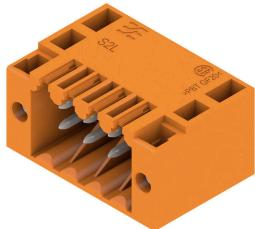
Abgewinkelte, zweireihige Stiftleiste in den Ausführungen seitlich geschlossen oder mit Flansch (seitlich offene Stiftleisten auf Anfrage). Die Stiftleisten mit der Stiftlänge 3,5 mm sind für das Wellenlöten ausgelegt und in einer Box-Verpackung. Ein Verschrauben mit der Leiterplatte ist möglich. Die Stiftleisten bieten Platz für Beschriftungen und können kodiert werden.
