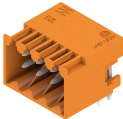
Abgewinkelte, zweireihige Stiftleiste in den Ausführungen seitlich geschlossen oder mit Flansch (seitlich offene Stiftleisten auf Anfrage). Die Stiftleisten mit der Stiftlänge 3,5 mm sind für das Wellenlöten ausgelegt und in einer Box-Verpackung. Ein Verschrauben mit der Leiterplatte ist möglich. Die Stiftleisten bieten Platz für Beschriftungen und können kodiert werden.
