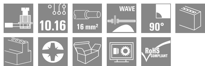
Diese Leiterplattenklemme mit bewährtem Zugbügelschluss im Raster 10,16 mm, Leiterabgangsrichtung in 90°-Ausführung bietet Anschlussmöglichkeiten für 76 A und 10,16 mm<sup>2</sup> Leiterquerschnitt.
