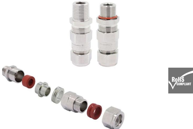
Kabelverschraubungen des Typs E1XZ sind für SWB-Stahldrahtgeflecht oder STA-Folienarmierung geeignet. Verschraubungen des Typs E1XZ erhalten den Explosionsschutz Ex d und Erhöhte Sicherheit Ex e. Und die Armierung sorgt für eine elektrische Verbindung zwischen der Kabelbewehrung und den Verschraubungen.
