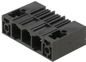
Einreihige Hochstrom-Stifteleiste, polverlustfrei anreihbar oder mit patentiertem Flansch zur schnellen, werkzeuglosen Verriegelung. Höchste Bedienungs- und Betriebssicherheit durch 100% fehlstecksicheres Steckgesicht, einzigartige Kodicervielfalt und Zusatzbefestigung im Flansch. Stiftlänge mit 3,5 mm optimiert für den Wellenlötprozess Steckrichtung 90° zu den Lötstiften.
