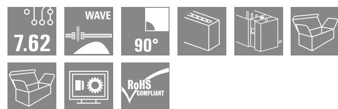
90°-Stifteleiste mit Lötflanschbefestigung im Raster 7.62 für IT-Netze 400 V nach IEC 61800-5-1.
