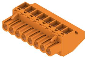
Buchsenstecker mit Schraubanschluss in Zugbügeltechnik für Leiteranschluss mit rechtwinkliger (90° bzw. 270°) Abgangsrichtung. Die Buchsenstecker bieten Platz für Beschriftungen und können kodiert werden. Befestigung mittels Flansch oder Löseriegel möglich. Sie bieten zusätzlich integrierte Plus/Minus-Schraube, Leiteruntersteckschutz und werden mit geöffnetem Zugbügel geliefert. HC = High Current.
