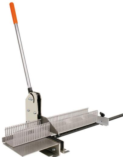
Verdrahtungskanalschneider für Handbetätigungen zum Schneiden von Verdrahtungskanälen und Deckeln bis 125 mm Breite und einer Wandstärke von 2,5 mm. Nur für nicht durch Füllstoffe verstärkte Kunststoffe.
