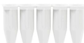
Durch den Einsatz von Reduzierhülsen wird das Anschließen von Leitern kleinerer Querschnittsbereiche vereinfacht. Leiter können sicher, ohne Abspießen der Litzen, in die Klemmstelle eingeführt werden. Der Leiter wird durch den Einsatz der Reduzierhülse in der Mitte der Leitereinführung zentriert.
