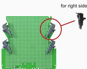
Stiftleisten mit optimierter Lötstiftlänge für Wellenlötanwendungen. Die Stiftleisten bieten Platz für Beschriftungen und können kodiert werden.
