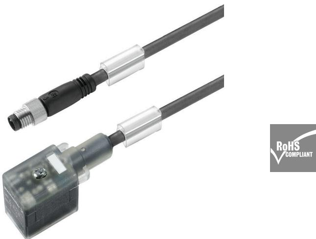
Weidmüller bietet Ventilstecker als Verbindungsleitung mit M8/M12 Steckern und mit freiem Leitungsende an. Der Betriebszustand des Ventilsteckers wird durch ein LED angezeigt. Die Ventilstecker besitzen eine Schutzbeschaltung. Das Weidmüllerlieferprogramm umfasst Ventilstecker der Bauformen A, B, C nach DIN und Industriestandard. Die Schutzart IP 67 wird im verschraubten Zustand erfüllt. Die Abgangsrichtung ist gleichfalls entscheidend, daher bietet Weidmüller unterschiedliche Versionen an.
