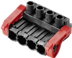
180°-invertierte Stiftleiste mit Zugbügelanschluss für die Feldverdrahtung in 2,5 mm<sup>2</sup> im Raster 7.62. Ideal auch als fingersichere Lösung bei Rückspannung.
