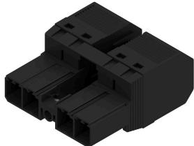
180°-invertierte, rückspannungssichere Stiftableiste mit PUSH IN Anschlusstechnologie für die Feldverdrahtung. Mit selbstständig verrastendem Mittenflansch für die Feldverdrahtung in 6 mm<sup>2</sup> im Raster 7.62. Ideal auch als fingersichere Lösung bei Rückspannung. Erfüllt die Anforderungen gemäß UL1059 600 V Class C und IEC 61800-5-1. Auf Anfrage auch ohne Mittenflansch lieferbar.
