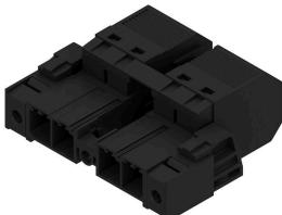
180°-invertierte Stiftleiste mit PUSH IN Anschlusstechnologie für die Feldverdrahtung in 6 mm<sup>2</sup> im Raster 7.62 als "Dreiflanschvariante" zur Gehäusedurchführung. Geeignet für Gehäuse mit einer Wandstärke von max. 2mm.
