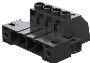
High Performance Stiftleiste mit dem bewährten, 100% wartungsfreien Weidmüller-Stahlzugbügel. Polverlustfrei anreichbar oder mit patentiertem Multifunktionsflansch zur sicheren, schnellen und werkzeuglosen Verriegelung. Höchste Bedienungs- und Betriebssicherheit durch 100% fehlstecksicheres Steckgesicht, einzigartige Kodiervielfalt, Fehlverdrahtungsschutz. Beschriftbar.
