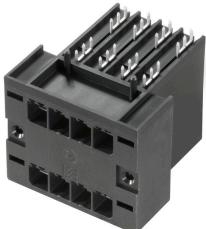
Zweireihige Hochstrom High Performance Stiftableisten, mit oder ohne Flansch zur schnellen, werkzeuglosen Verriegelung. Optimierte für „Book-Size Module“ ab einer Baubreite von 50mm. Mit integrierte Befestigungsmöglichkeit an der Gehäusewand. Höchste Bedienungs- und Betriebssicherheit durch 100% fehlstecksicheres Steckgesicht, einzigartige Kodiervielfalt und optional zusätzlicher Schraubbefestigung im Flansch.
