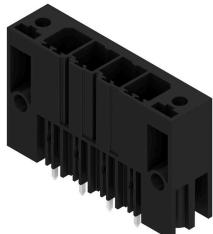
Einreihige High Performance Stifteleiste, polverlustfrei anreihbar oder mit patentiertem Flansch zur schnellen, werkzeuglosen Verriegelung. Höchste Bedienungs- und Betriebssicherheit durch 100% fehlstecksicheres Steckgesicht, einzigartige Kodiervielfalt und Zusatzbefestigung im Flansch. Stiftlänge mit 3,5 mm optimiert für bleifreies Wellenlöten.
