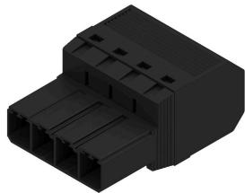
180°-invertierte Stifteleiste mit PUSH IN Anschlusstechnologie für die Feldverdrahtung in 6 mm<sup>2</sup> im Raster 7.62 als "Dreiflanschvariante" zur Gehäusedurchführung. Geeignet für Gehäuse mit einer Wandstärke von max. 2mm. Ideal auch als fingersichere Lösung bei Rückspannung. Erfüllt die Anforderungen gemäß UL1059 600 V Class C und IEC 61800-5-1
