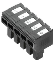
Energieverteilung mit ungeschnittener Leitung mit Leitungsquerschnitten von 1,5 bis 6mm<sup>2</sup>. Einspeisung / T-Abzweig über PUSH IN Anschluss 0,5 bis 10 mm<sup>2</sup> und/oder Steckanschluss 0,5 bis 4mm<sup>2</sup>. Farbige Markierungen ermöglichen eine eindeutige Leiterzuordnung.
