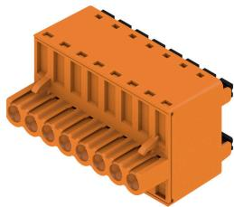
Die starke "Daisy-Chain"-Lösung für leistungsstarke Signalbus-Anwendungen eignet sich auch für 400V-Hilfsenergie-Ketten bis 18,5A Stromtragfähigkeit. Das große Klemmvermögen bis 2,5mm<sup>2</sup> Leiterquerschnitt ist aufgrund des geringen Spannungsfalls besonders vorteilhaft bei langen Busleitungen oder hohen Strömen. Die 4 Flanschvarianten inclusive patentiertem Löseriegel ermöglichen ein anwenderorientiertes Verriegelungskonzept.
