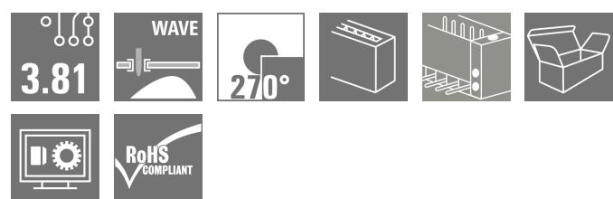
Die Stifteleiste SC in 270°-Abgangsrichtung - der Winkel von 270° wird definiert zwischen Steckrichtung und Löt-pin und kennzeichnet die Steckrichtung parallel zur Leiterplatte, jedoch für das Stecken von Buchsenleisten über Kopf.
