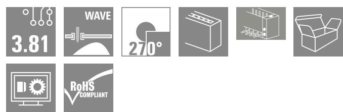
Die Stifteleiste SC in 270°-Abgangsrichtung - der Winkel von 270° wird definiert zwischen Steckrichtung und Löt-pin und kennzeichnet die Steckrichtung parallel zur Leiterplatte, jedoch für das Stecken von Buchsenleisten über Kopf.
