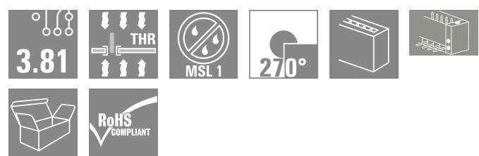
Die hochtemperaturfeste Stiftleiste SC-SMT in 270°-Abgangsrichtung - der Winkel von 270° wird definiert zwischen Steckrichtung und Lötpin und kennzeichnet die Steckrichtung parallel zur Leiterplatte, jedoch für das Stecken von Buchsenleisten über Kopf.
