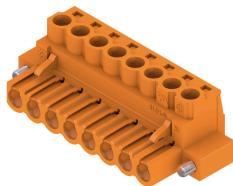
Buchsenstecker mit Schraubanschluss in Zugbügeltechnik für Leiteranschluss mit gerader (180°) Abgangsrichtung. Die Buchsenstecker bieten Platz für Beschriftungen und können kodiert werden. Befestigung mittels Flansch oder Löseriegel möglich. Sie bieten zusätzlich integrierte Plus/Minus-Schraube, Leiteruntersteckschutz und werden mit geöffnetem Zugbügel geliefert. HC = High Current.
