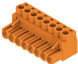
Buchsenstecker mit Schraubanschluss in Zugbügeltechnik für Leiteranschluss mit gerader (180°) Abgangsrichtung. Die Buchsenstecker bieten Platz für Beschriftungen und können kodiert werden. Befestigung mittels Flansch oder Löseriegel möglich. Sie bieten zusätzlich integrierte Plus/Minus-Schraube, Leiteruntersteckschutz und werden mit geöffnetem Zugbügel geliefert. HC = High Current.
