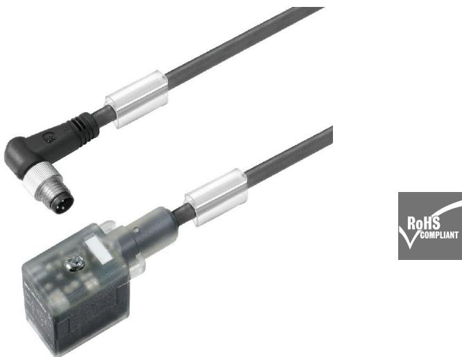
Weidmüller bietet Ventilstecker als Verbindungsleitung mit M8/M12 Steckern und mit freiem Leitungsende an. Der Betriebszustand des Ventilsteckers wird durch ein LED angezeigt. Die Ventilstecker besitzen eine Schutzbeschaltung. Das Weidmüllerlieferprogramm umfasst Ventilstecker der Bauformen A, B, C nach DIN und Industriestandard. Die Schutzart IP 67 wird im verschraubten Zustand erfüllt. Die Abgangsrichtung ist gleichfalls entscheidend, daher bietet Weidmüller unterschiedliche Versionen an.
