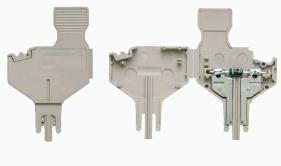
Der Bauelementstecker dient dem integrieren einer elektrischen Komponente in einer Trennreihenklemme. Nach dem Einlöten der jeweiligen Komponente lässt sich der Stecker in den Trennbereich unserer Reihenklemmen integrieren und ändert dadurch die Trennklemme zu einer Reihenklemme mit integrierter elektronischen Komponente.
