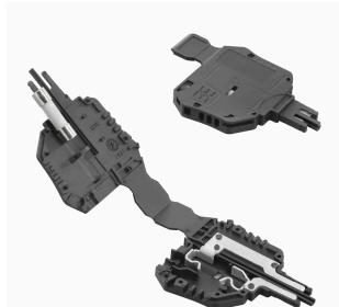
Der Sicherungshalter SIHA macht im Handumdrehen aus einer Trennklemme eine Sicherungsklemme: Einfach den Trennhebel entfernen und den Sicherungsstecker aufstecken.
