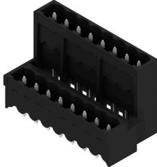
Hochtemperaturfeste, doppelstöckige, seitlich versetzte, geschlossene Stifteleiste optional mit Lötflansch. Lötstift 1,5 mm für Reflowlötanwendungen geeignet. Lötstift 3,2 mm für Reflow- und Wellenlötanwendungen geeignet. Die Stifteleisten bieten Platz für Beschriftungen und können kodiert werden.
