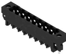
Hochtemperaturfeste Stifteleiste mit Verpackung in Box oder Tape. Im Tape mit 1,5 mm Lötstift optimiert für die Automatenbestückung. Lötstift 3,2 mm für Reflow- und Wellenlötanwendungen geeignet. Die Stifteleisten sind beschriftbar und können kodiert werden. HC = High Current.
